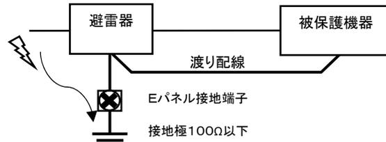
保護したい機器のフレームグランド端子を避雷器の端子Eに接続してからパネルの接地端子に接続すると、被保護機器に誘導雷サージが及ばないようになります。
