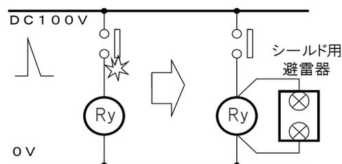
誘導負荷による過電圧は10～20倍位になります。接点がON状態になるとスパークで溶着することがあります。シールド用避雷器をリレーの両端に設置することで、過電圧を抑えて溶着を防ぎます。
