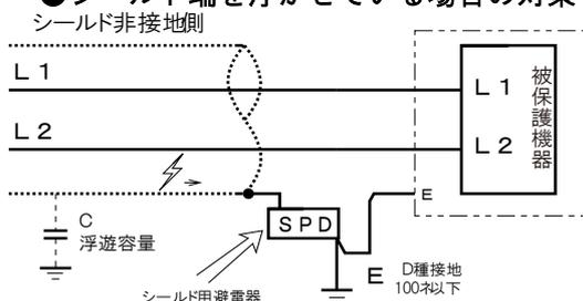
現場によってはノイズ対策のために、片方のシールド線を接続していない（浮かせている）場合があります。ですが、シールド線にC（浮遊容量）が溜まっているため、雷サージが来た際に機器に飛ぶ危険性があります。シールド用避雷器を設置することで過電圧をアースへ逃がします。
