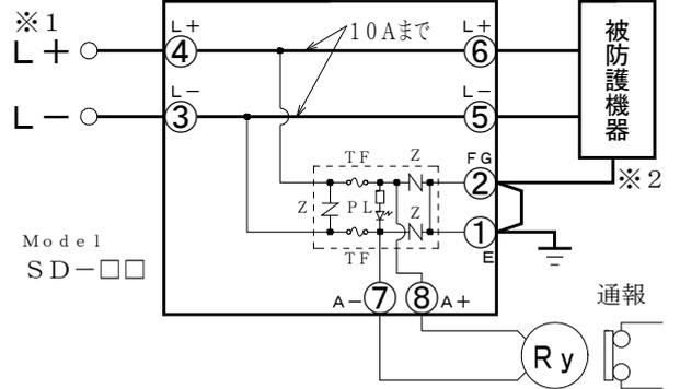
※1 直流での動作電圧試験の場合は、逆極性でおこなってください。符号通りの場合、表示ランプテストとなります。
