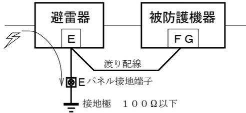
防護したい機器のフレームグランド端子を避雷器の端子Eに接続してからパネルの接地端子に接続すると、被保護機器に誘導雷サージが及ばないようにします。
