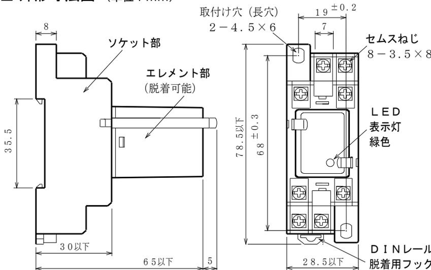
本器は交流電源のケーブルに生じた誘導雷サージを吸収し、電子機器を防護する避雷器です。内蔵のヒューズはエレメントの短絡時電源に影響をあたえないために設けてあります。
