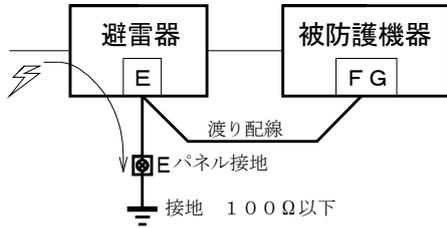
防護したい機器のフレームグランド端子を避雷器の端子Eに接続してからパネルの接地端子に接続すると、被防護機器に誘導雷サージが及ばなくなります。
