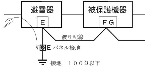
保護したい機器のフレームグランド端子を避雷器の端子Eに接続してからパネル接地端子に接続すると被保護機器に誘導雷サージが及ばないようになる。
